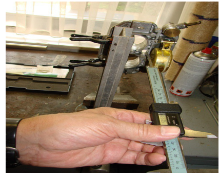
Afbeelding 16: Controleren van het vlotterniveau
